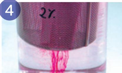
4 Études de détachement avec nettoyant selon le TACT (Time Action Concentration Temperature) avec et sans action mécanique.
